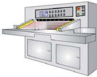
Eksempel på håndbeskyttelse montert horisontalt.
