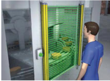
Eksempel på håndbeskyttelse montert vertikalt.
